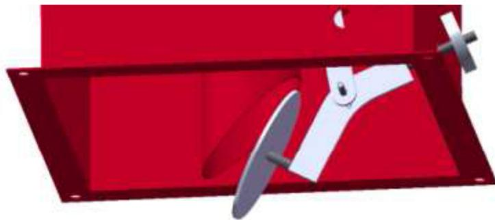
L'aspirateur est livré avec le contrepoids calibré, mais il est possible qu'en raison des vibrations lors du transport et de la manutention, celui-ci se dérègle.
