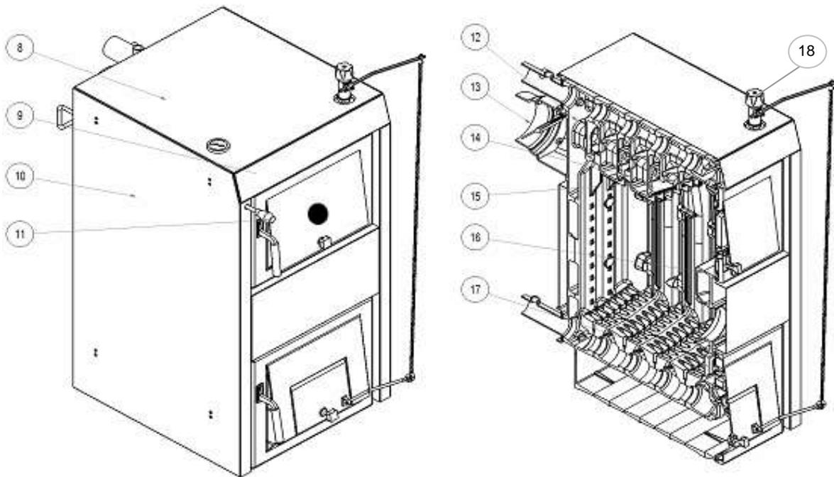
**Fig. n° 3 Schéma de la chaudière 3 à 7 éléments**
