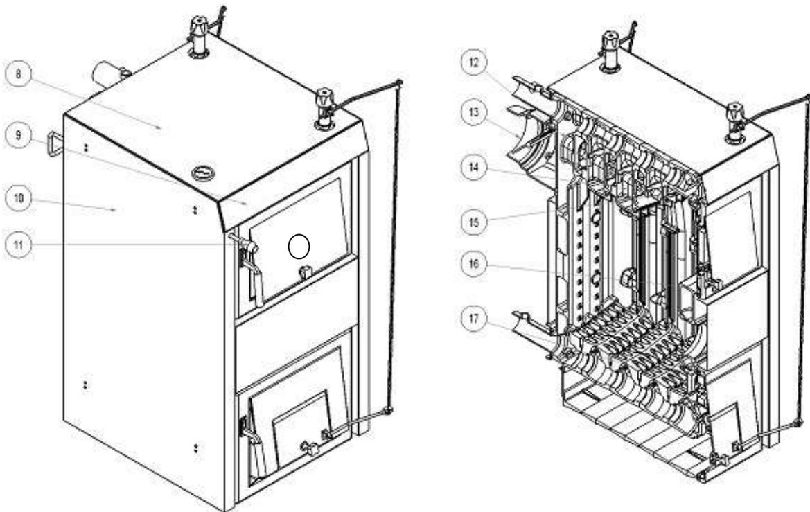
**Fig. n° 3 Schéma de la chaudière 8 à 10 éléments**
