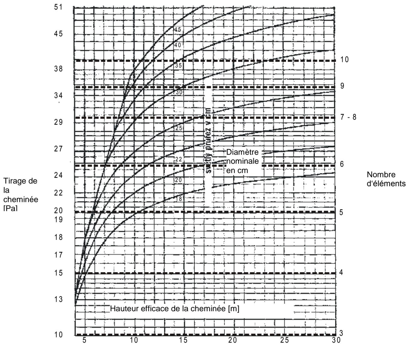
Fig. n° 2 Détermination du diamètre de la cheminée
