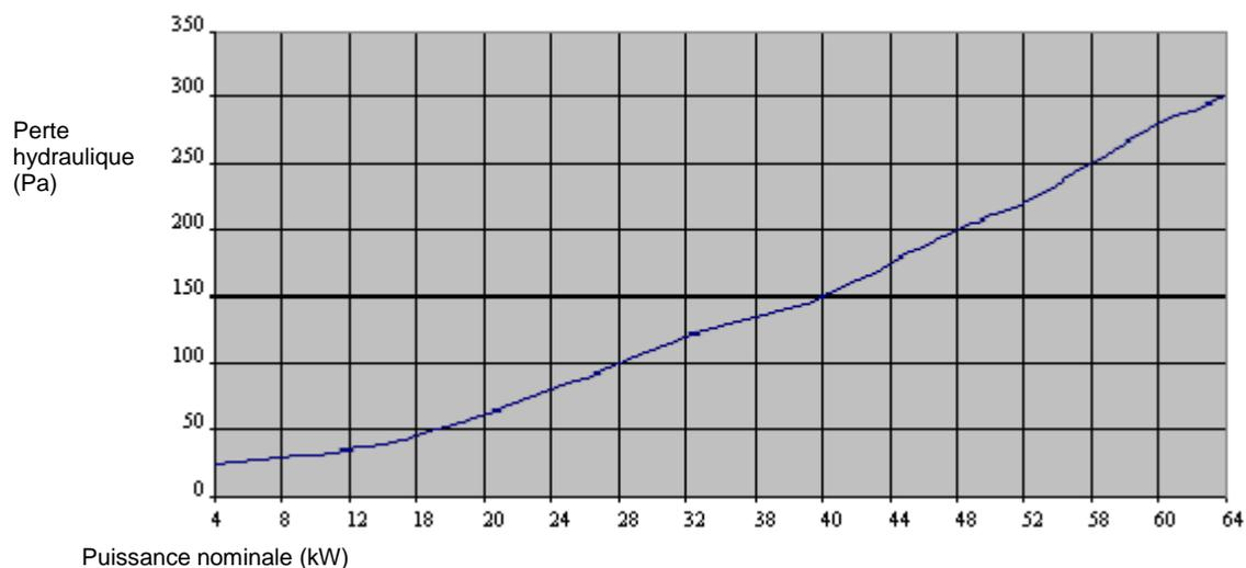
Fig. n° 1 Perte hydraulique du corps de la chaudière
