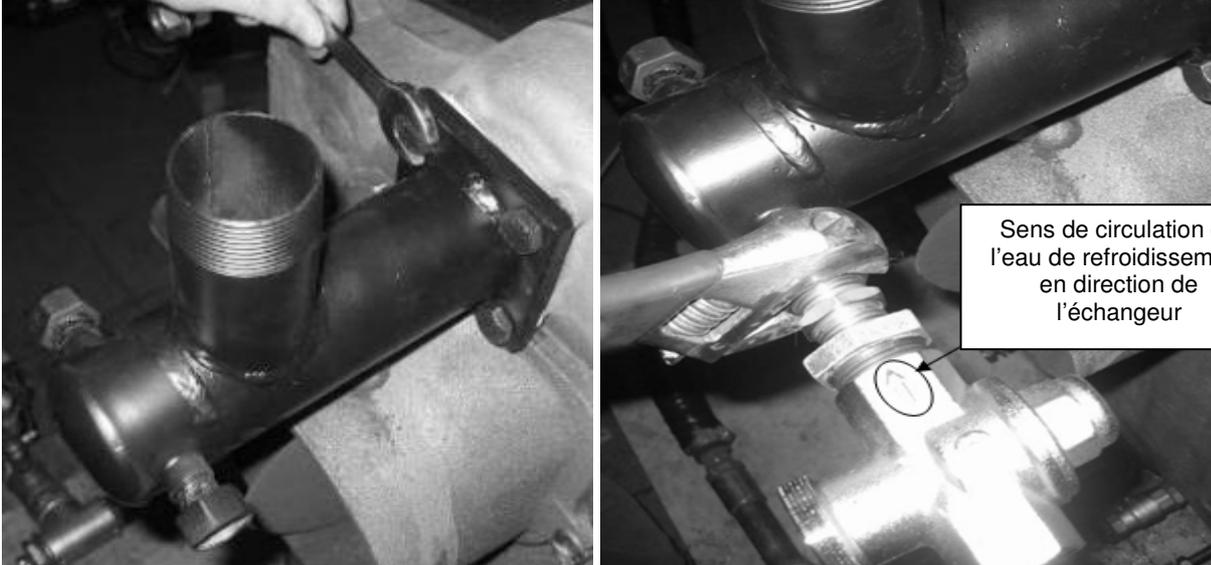
Sens de circulation de l'eau de refroidissement en direction de l'échangeur
