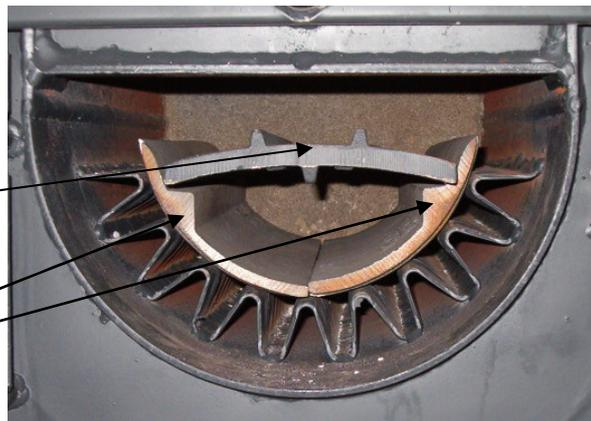
Le catalyseur supérieur se pose sur le catalyseur inférieur. Il n'y a pas de sens pour la pose. Il doit être positionné vers l'avant et venir en butée sur la porte pour assurer le triple parcours des fumées.
