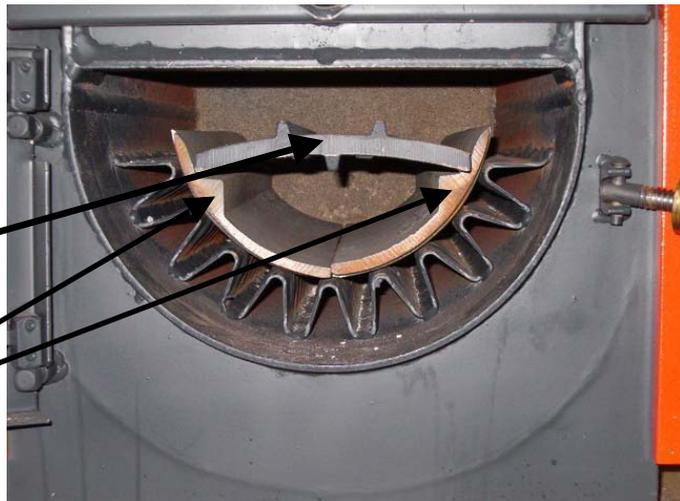
Le catalyseur supérieur se pose sur le catalyseur inférieur. Il n'y a pas de sens pour la pose. Il doit être positionné vers l'avant et venir en butée sur la porte pour assurer le triple parcours des fumées.
