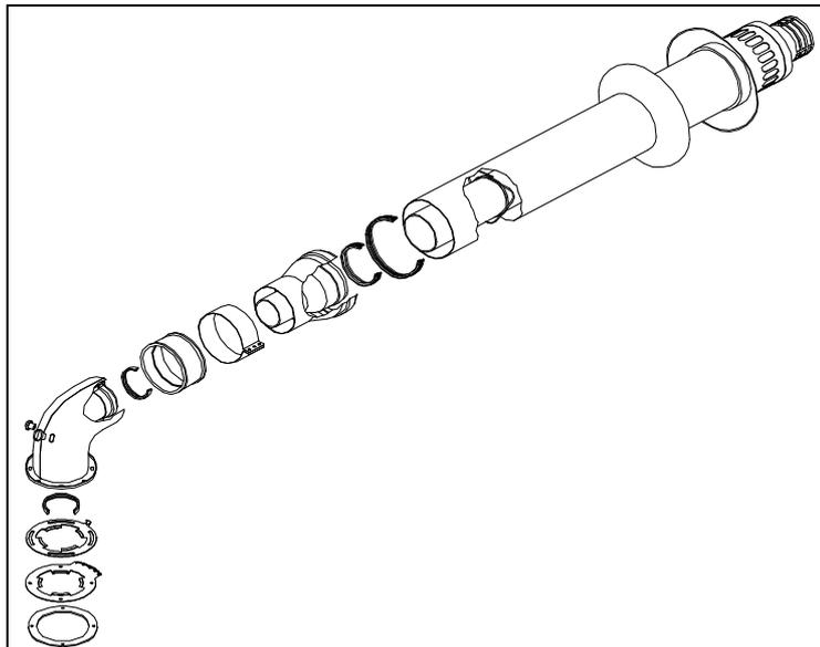
Il est adapté uniquement pour **les chaudières à ventouse**. Il permet d'évacuer les gaz de combustion et d'aspirer l'air pour la combustion au moyen de deux conduits coaxiaux, un conduit extérieur Ø125 pour l'aspiration de l'air et un conduit intérieur Ø80 pour l'évacuation des fumées.
