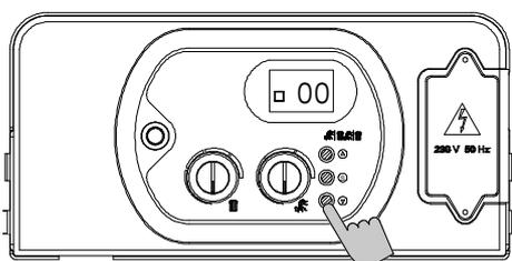
6. - En cas d'installations avec vannes de zone, régler le paramètre 15 sur « 01 ». Si une commande à distance est installée, ajouter une carte d'interface pour commander les vannes de zone et régler le paramètre sur « 01 ».
