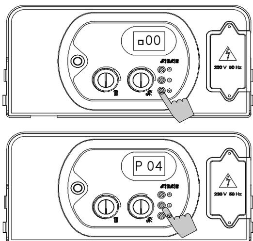
**Paramètre 04 – Sélection du fonctionnement de la pompe en mode chauffage**
