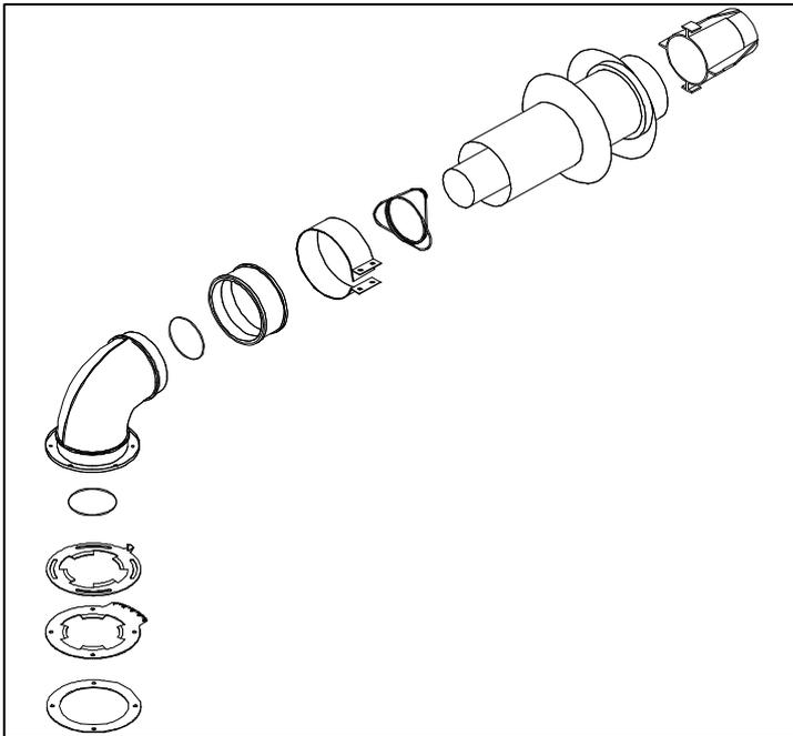
Il est adapté uniquement pour les **chaudières à ventouse**. Il permet d'évacuer les gaz de combustion et d'aspirer l'air pour la combustion au moyen de deux conduits coaxiaux, un conduit externe pour l'aspiration de l'air, un conduit interne pour l'évacuation des fumées.
