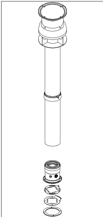
Il est adapté uniquement pour les chaudières à ventouse de ce type. Il permet d'évacuer les gaz de combustion et d'aspirer l'air pour la combustion au moyen de deux conduits coaxiaux, un conduit extérieur Ø100 pour l'aspiration de l'air et un conduit intérieur Ø60 pour l'évacuation des fumées.
