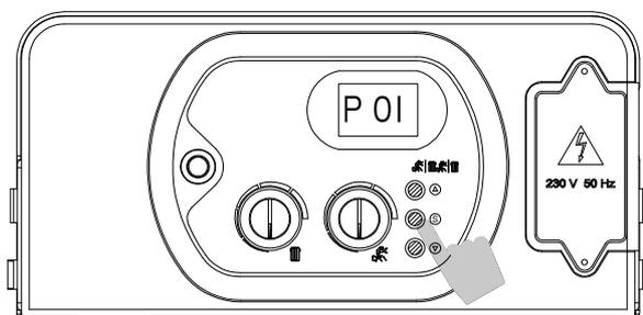
5. Une fois le paramètre choisi affiché, relâcher la touche « S » (affichage « P » clignotant et numéro de paramètre fixe). Appuyer à nouveau sur la touche « S » et relâcher : l'afficheur visualisera la valeur du paramètre à modifier.
