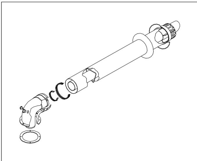
**Il est adapté uniquement aux chaudières à condensation.** Il permet d'évacuer les gaz de combustion et d'aspirer l'air pour la combustion au moyen de deux conduits coaxiaux, un conduit extérieur Ø100 pour l'aspiration de l'air et un conduit intérieur en plastique Ø60 pour l'évacuation des fumées.
