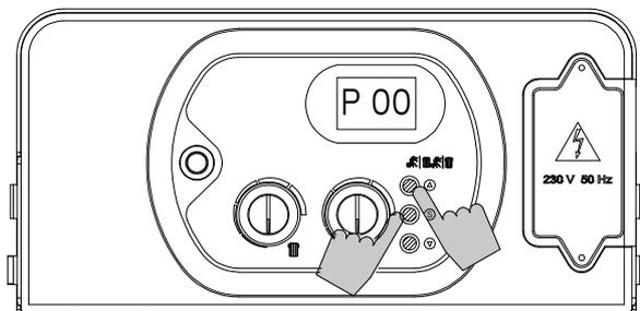
4. Appuyer et maintenir la touche « S » appuyée. Sélectionner le paramètre à modifier au moyen des touches « $\Delta$ » et « $\nabla$ ».
