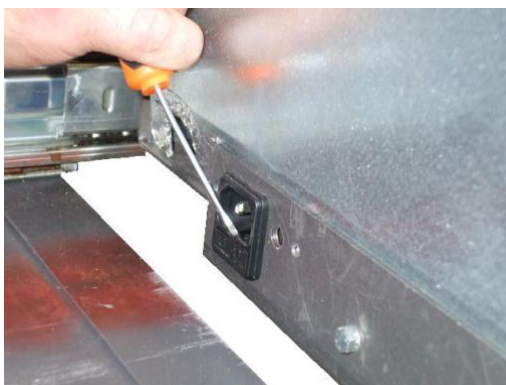
Fig. 55 - Enlèvement du fusible sur la prise électrique
