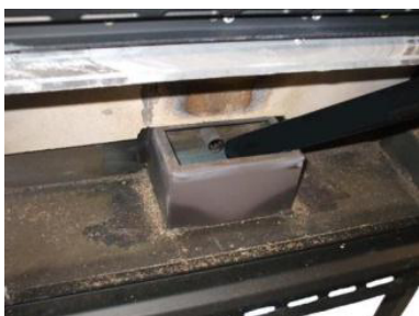
Fig. 36 - Nettoyage du logement du brasero
