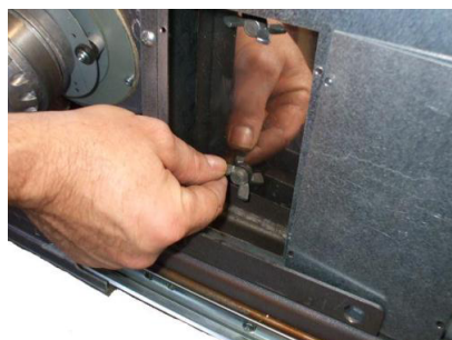
Fig. 46 - Extraction du 2° panneau
