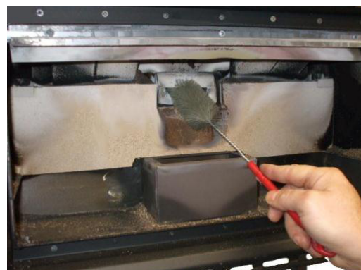
Fig. 35 - Nettoyage avec goupillon
