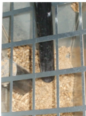
Fig. 39 - Nettoyage réservoir et vis sans fin
