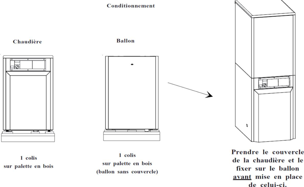
**Pour manipuler votre chaudière, utiliser 2 barres de manutention et insérer-les dans les orifices prévus dans les pieds avant et arrière du bloc fonte (Voir vue face arrière page suivante). Pour manipuler le ballon E.C.S., consulter également la page suivante (face arrière ballon : traverse de manutention).**
