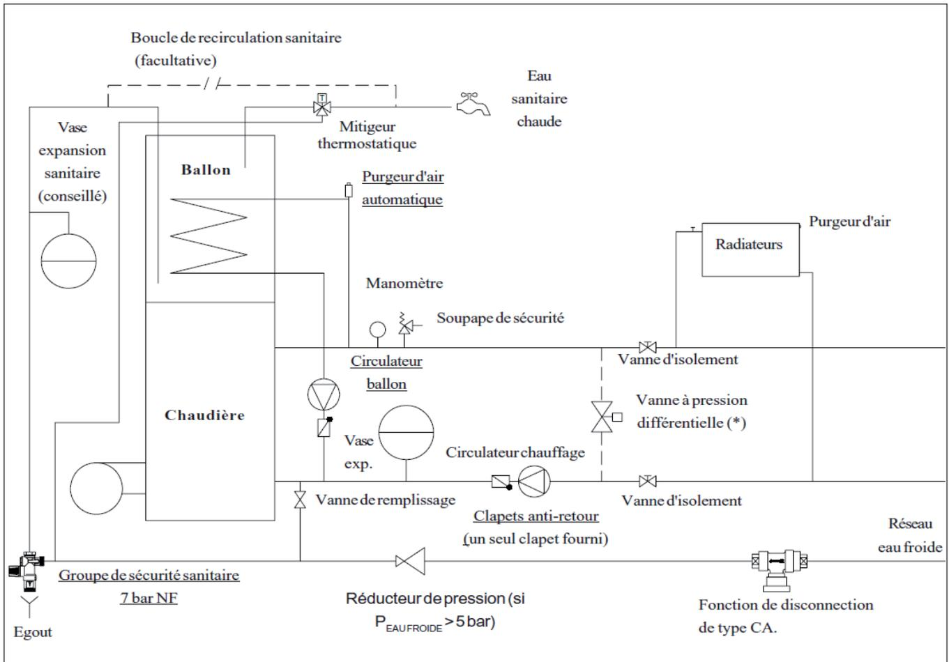
(\*) Au cas où tous les radiateurs de l'installation sont pourvus de vannes thermostatiques et/ou en cas de fermeture des vannes d'isolement du circuit chauffage, prévoir une vanne à pression et différentielle entre le départ et le retour chaudière
