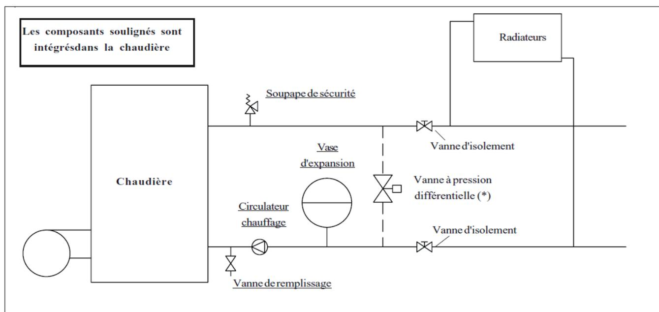
\* Au cas où tous les radiateurs de l'installation sont pourvus de vannes thermostatiques et/ou en cas de fermeture des vannes d'isolement du circuit chauffage, prévoir une vanne à pression différentielle entre le départ et le retour chaudière.
