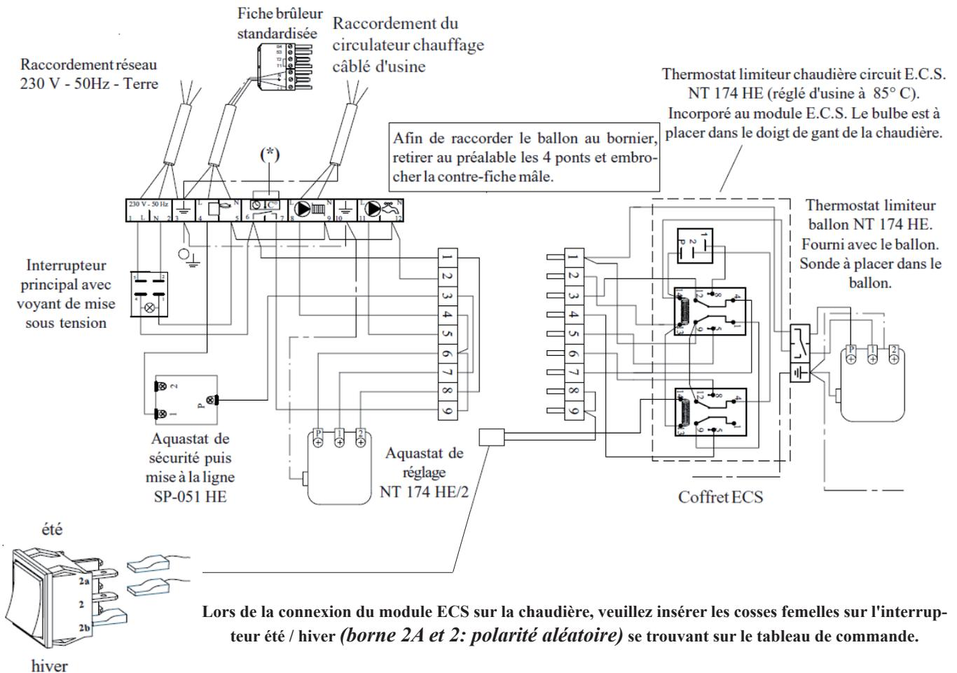
En cas d'utilisation d'une régulation ou d'un thermostat d'ambiance, enlever le pontage du thermostat d'ambiance (\*) entre les bornes 6 et 7 du bornier principal. En cas d'utilisation, des régulations L321C ou L634C, enlever le coffret ECS.
