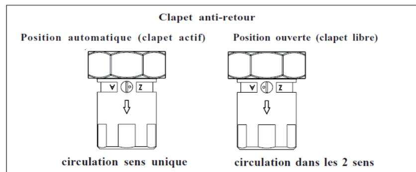
Lors du remplissage d'une installation avec ballon positionner le clapet anti-retour en position ouverte (circuit réchauffage ballon) et remettre celui-ci en position automatique après une première mise à température (voir ci-contre). Ceci afin de favoriser la purge complète du circuit de réchauffage du ballon.
