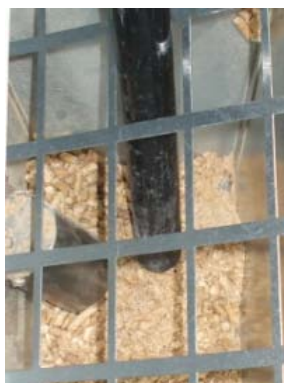
Fig. 32 - Nettoyage réservoir et vis sans fin
