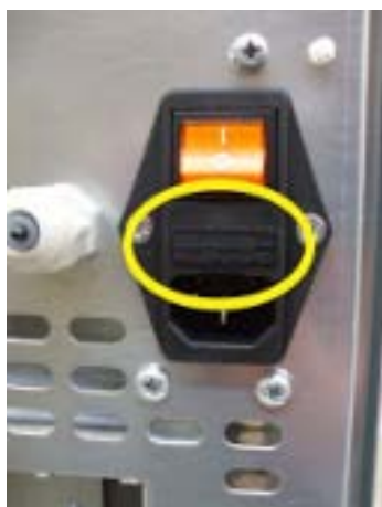
Fig. 56 - Hublot avec les fusibles à enlever
