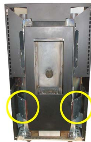
Fig. 49 - Passages des fumées
