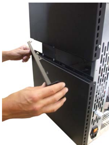
Fig. 51 - Enlèvement du panneau central
