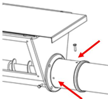
Pour assurer un bon fonctionnement de l'ensemble, il est impératif que le couvercle de fermeture du pot d'extraction ne soit ouvert que de 2 cm environs.
