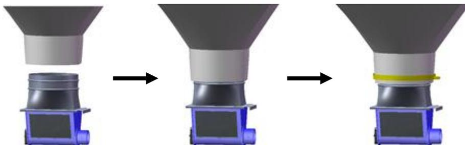
Insérer le tube en PVC (partie avec une découpe) dans le pot d'extraction.
